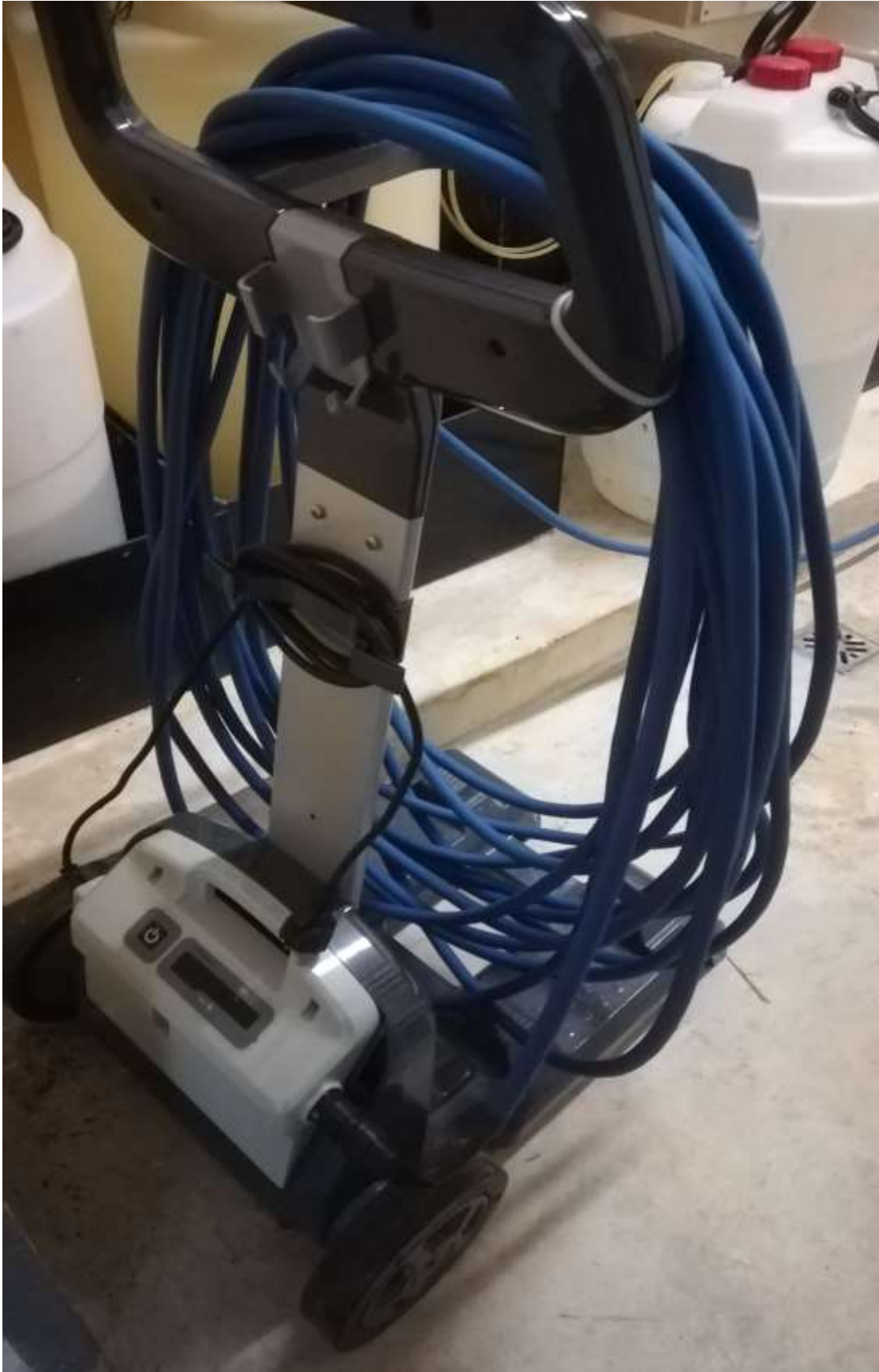
bazénový vysavač – nadzemní část
