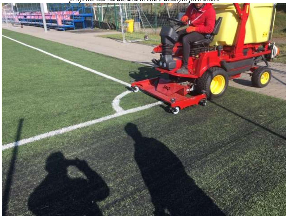
střednědobá údržba hřiště s umělým povrchem
